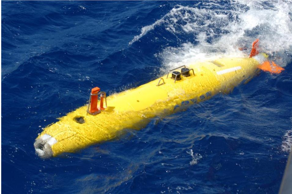
AUV Abyss – Eine autonome Drohne für Einsatzgebiete bis 6000m Tiefe
